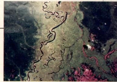
Imagem de satélite da Lagoa das Onças, que funciona como uma balança hidráulica entre duas bacias hidrográficas.
