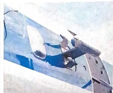
O Electra voando: sensores na fuselagem e câmara de vídeo na asa
