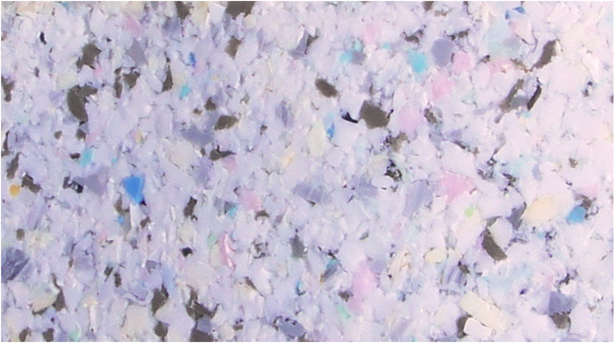
Fabricantes especializados transformam as espumas em placas prensadas, usadas como forro de carpetes ou isolantes térmicos
