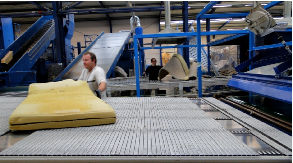
Apenas 5% do trabalho é manual, incluindo a retirada dos tecidos
