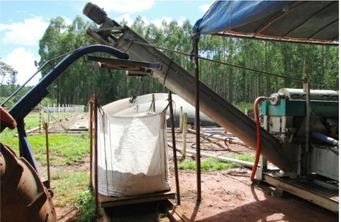
9. A máquina recicladora seca e embala o biofertilizante sólido, retirado do biodigestor (ao fundo).
