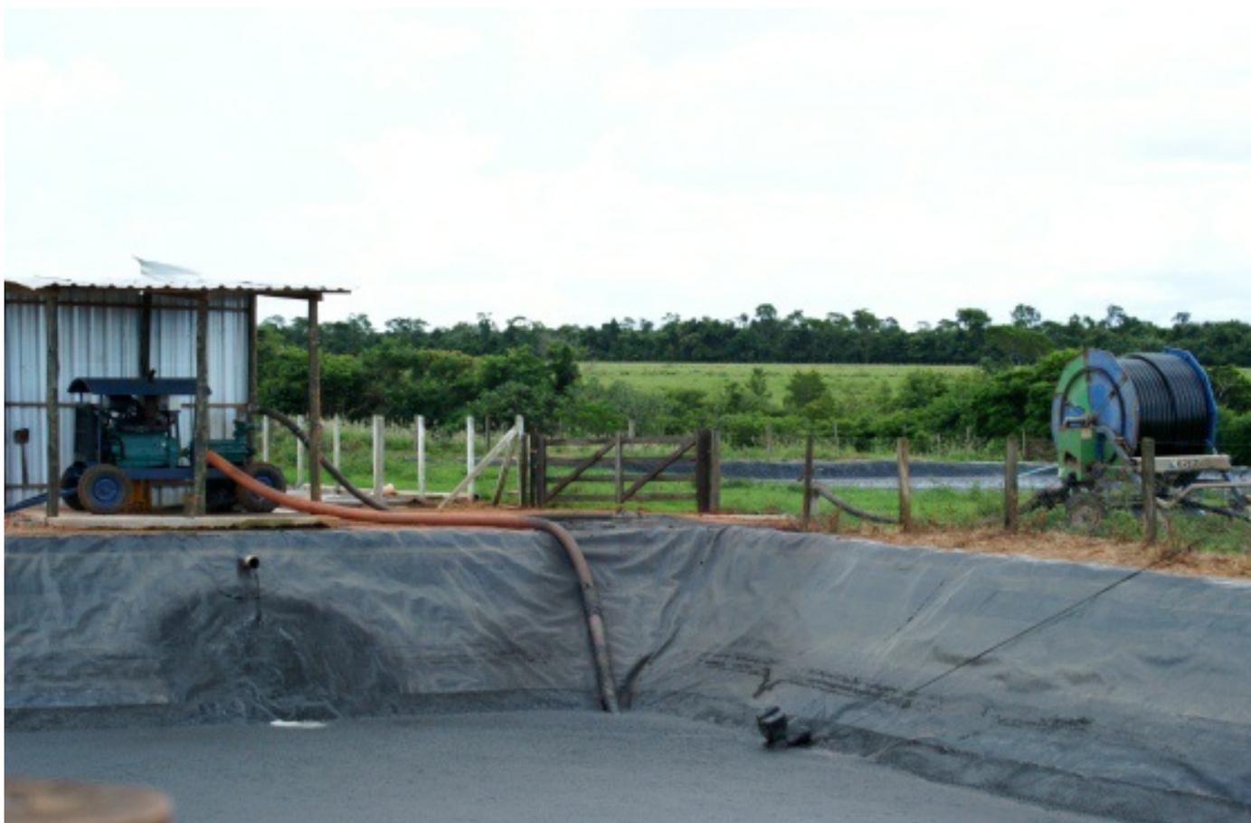
2. O motor movido a biogás (à esq) bombeia o biofertilizante líquido da lagoa para o carretel (à dir), cuja mangueira está conectada a um aspersor
