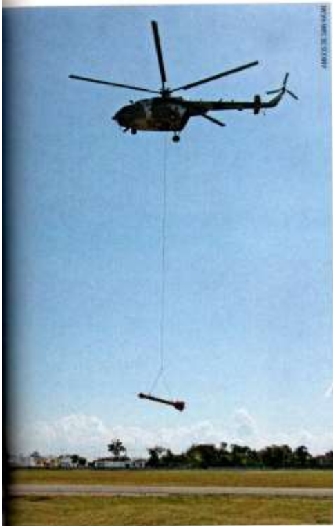
RIOS SUBTERRÂNEOS - O sensor em forma de torpedo, rebocado pelo helicóptero, localiza os cursos d'água subterrâneos. A dir., um chultun, cisterna construída há 2 mil anos para armazenar água. Na pág. anterior, à esq., abaixo, cenote de laguna no meio do mangue, com passarela de acesso; acima, cenote de caverna com cordas para quem não sabe nadar e entrada de luz natural; e cenote de caverna com estalactites
